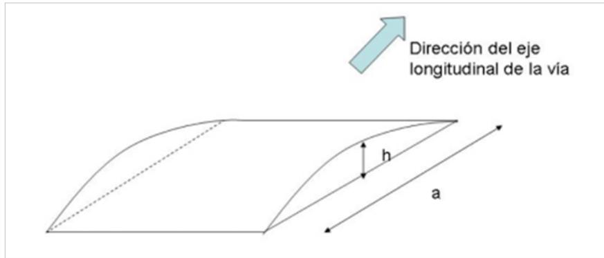
*Reductores de velocidad prefabricados*
