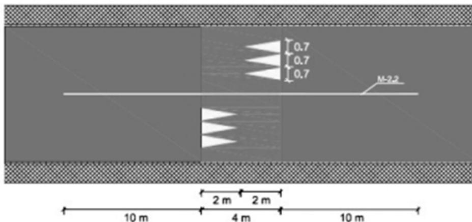
Los ralentizadores de este tipo no pueden emplearse como paso para peatones, por lo que debe reducirse a lo imprescindible su utilización. La señalización está constituida por 3 triángulos blancos realizados sobre la parte ascendente del lomo (ver figura adjunta).
